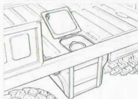
Lo sportellino, al pianale, che ricopre il tappo del serbatoio carburante. A fianco del serbatoio è la ruota di scorta.
