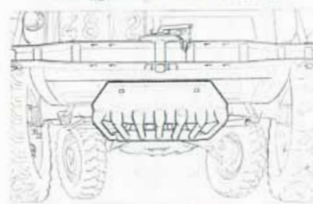
Il motore è protetto inferiormente dagli urti con una grembiatura formata da tubi.
