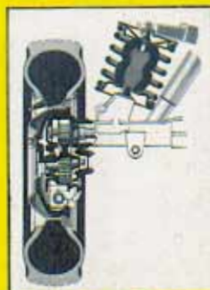
DAS 'RÜCKGRAT' des Haflinger bildet ein Zentralrohrrahmen, in dem die Antriebswelle für den Allradantrieb läuft. Die Pendelachsen vorn und hinten hängen in röhrenförmigen Stahlblechkörpern. Radantrieb exzentrisch durch Stirnradübersetzung (oben).
